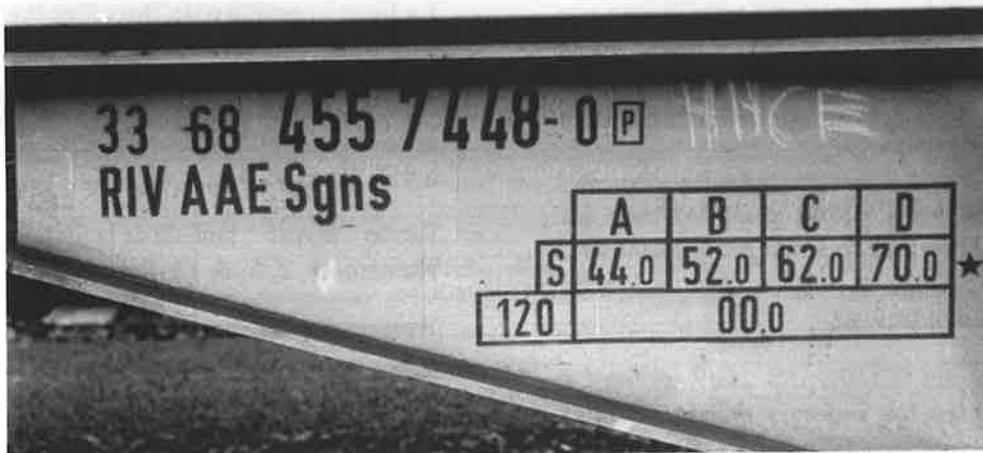
*Wagon Sgns : le tableau indique que ce wagon, d'une tare de 20 t, peut être chargé à 70 t, si la voie supporte 22,5 t à l'essieu. A 120 km/h il ne peut circuler qu'à vide. Photo G.B.*
